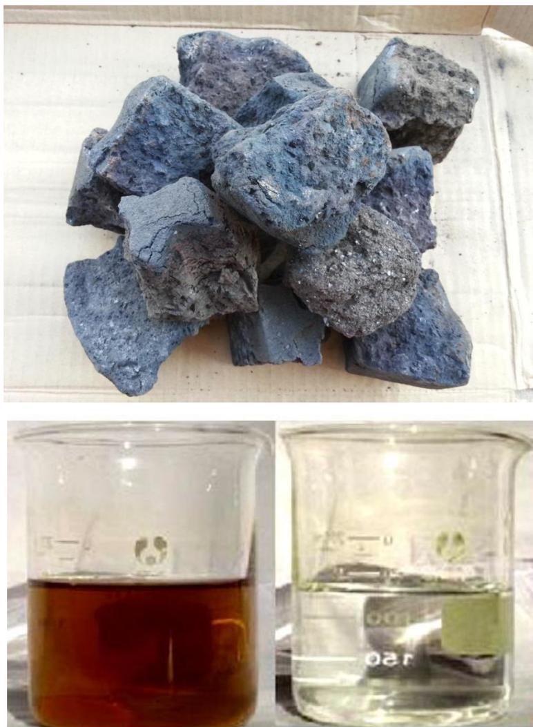
铁碳微电解法，是目前处理高浓度有机废水的一种理想工艺，又称内电解法。它是在不通电的情况下,利用填充在废水中的微电解材料自身产生 1.2V 电位差对废水进行电解处理，以达到降解有机污染物的目的。
